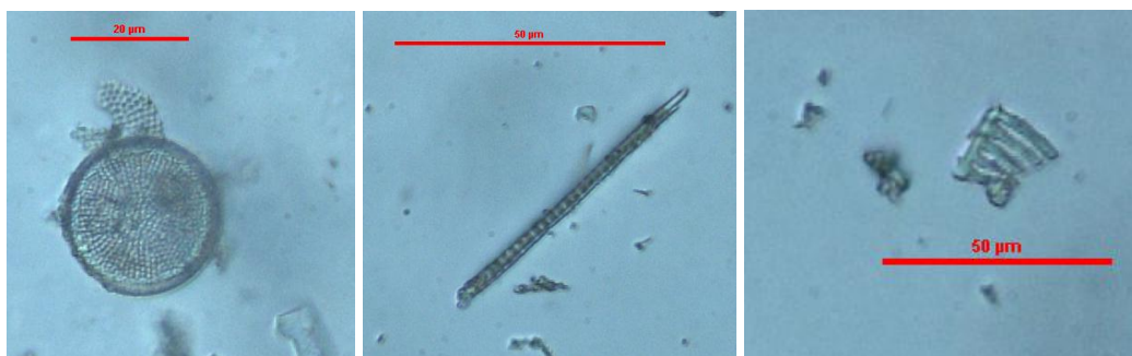
Slika 2: Raznolikost diatomej v testiranih diatomejskih zemljah iz več Evropskih nahajališč. Fotografije so posnete pod optičnim mikroskopom Nikon Eclipse 80i (foto: H. Rojht).
